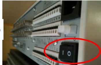
②デジタルレコーダーの電源を落とす: デジタルレコーダー背面にある電源スイッチをOFFにします。
