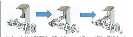
ツマミ・もしくはカギを差込み、回転させることで、内部のカムが手前に引き込みます。
