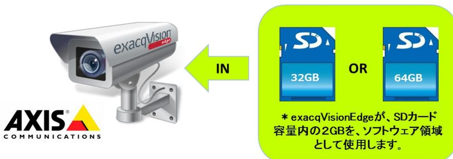
exacq Edgeは、IPカメラに搭載されたSDカードに、exacqVisionのVMS(ビデオ・マネジメント・ソフトウェア)をインストールすることで、SDカードへの映像録画など、カメラ単体での監視ソリューションをご提供いたします。
