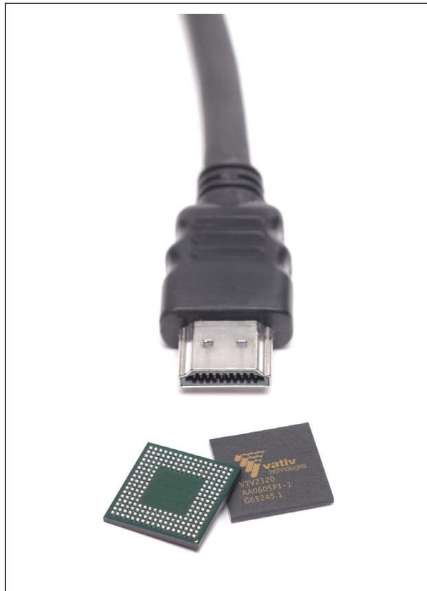
VTV2320 パッケージサイズ:(W)17mm×(D)17mm×(H)1.71mm 256pin
