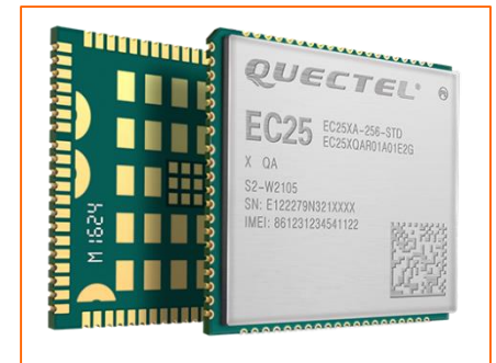
通信モジュール
