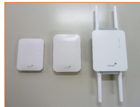
無線LANシステム(基地局)
